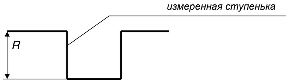
Рис.5. Измерение толщины пленки на профилографе - профилометре
