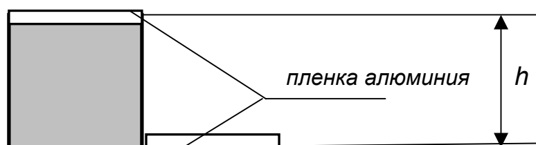
Рис.3. Измерение толщины пленки на микроинтерферометре МИИ-4.
